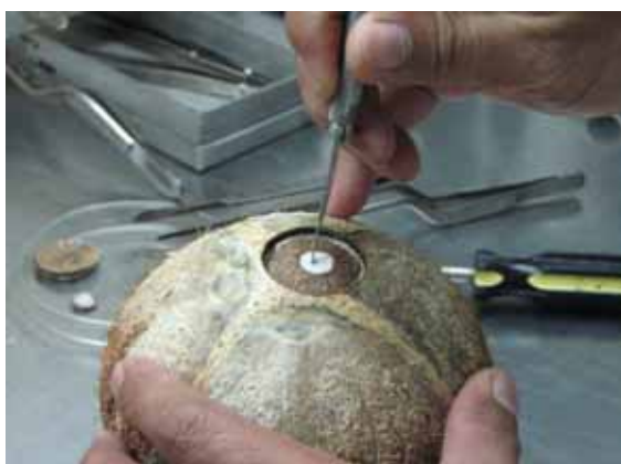
Hình 6. Tách rời phần chóp của vỏ hạt (vỏ gáo dừa) ra ngoài
