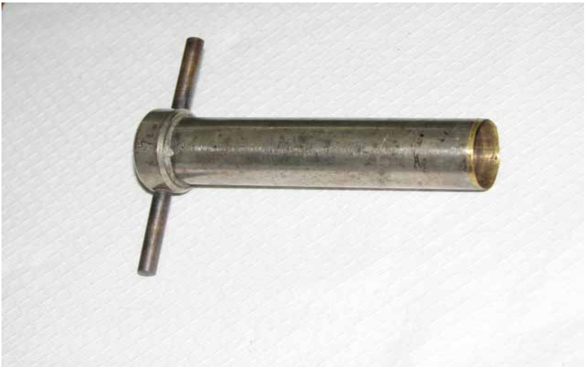
Hình 2. Dụng cụ khoan lấy miếng nội nhũ hình trụ chứa phôi mầm ra khỏi hạt giống.
