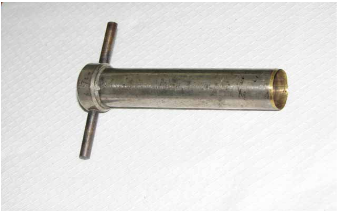
Gambar 2. Bor yang digunakan untuk mengambil penyumbat endosperm dari batok yang telah dibelah.
